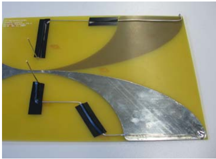
Abb. 7. Links: 5 kV-Vivaldiantenne der FH-Gelsenkirchen und rechts: abgestrahlter DS-Puls mit UWB-Anteil.
