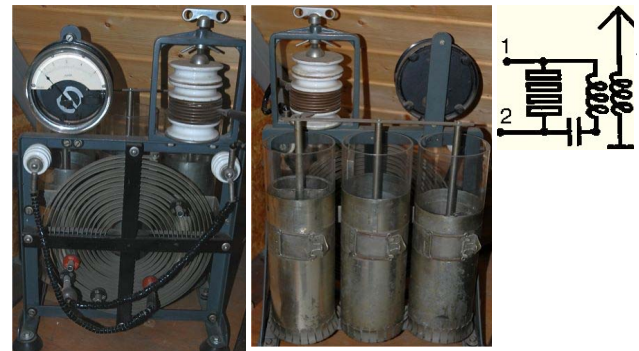
Abb. 4. DS-Sender (Lösch funkensender) TK05 von Telefunken mit 500 Hz-Reprate. Links Ansicht von vorn mit variabler Selbstinduktion, Amperemeter und Löschfunkenstrecke, mitte: Ansicht von hinten mit den drei Leydener Flaschen des Stoßkreises, rechts: Schaltbild mit Löschfunkenstrecke und Kondensator im Primärkreis (Stoßkreis).
